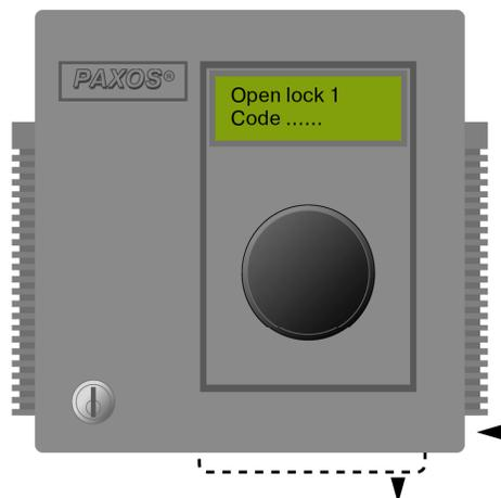
В замке используются 6 щелочных (alkaline) батарей типа AA (пальчиковые) напряжением 1,5 В. Они установлены в нижней части замка и закреплены винтом. Для замены — открутите винт и, потянув вниз, выньте блок с батарейками.
