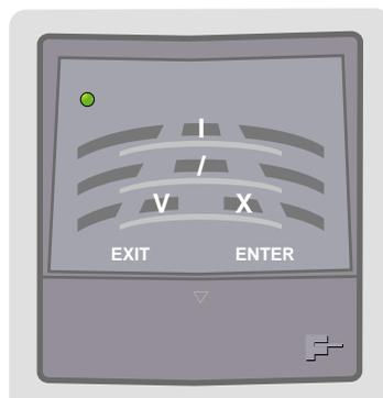
Если при наборе кода индикатор мигает 5 раз или замок не реагирует на нажатия кнопок — необходимо заменить батарейку. Используется 1 щелочная (alkaline) 9В (тип 6LR61) батарейка. Для её замены нужно сдвинуть панель под клавиатурой вниз, перевести рычажок вправо и опустить панель вниз до конца. Заменяв батарейку, верните панель в исходное положение.
